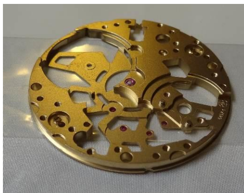
IMAGE 2: Photographie de la platine pré-usinée après découpe des ouvertures par Laser-MicroJet® (vue supérieure)
