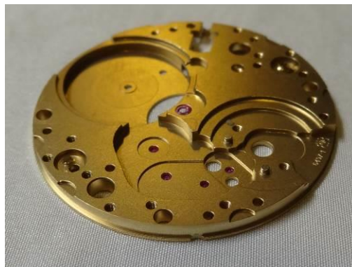
IMAGE 1: Photographie de la platine pré-usinée (vue supérieure)
