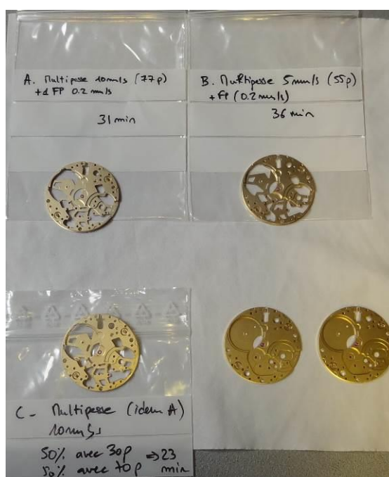
IMAGE 3: Photographie des platines usinées (A-B-C) par Laser-MicroJet® (vue supérieure)
