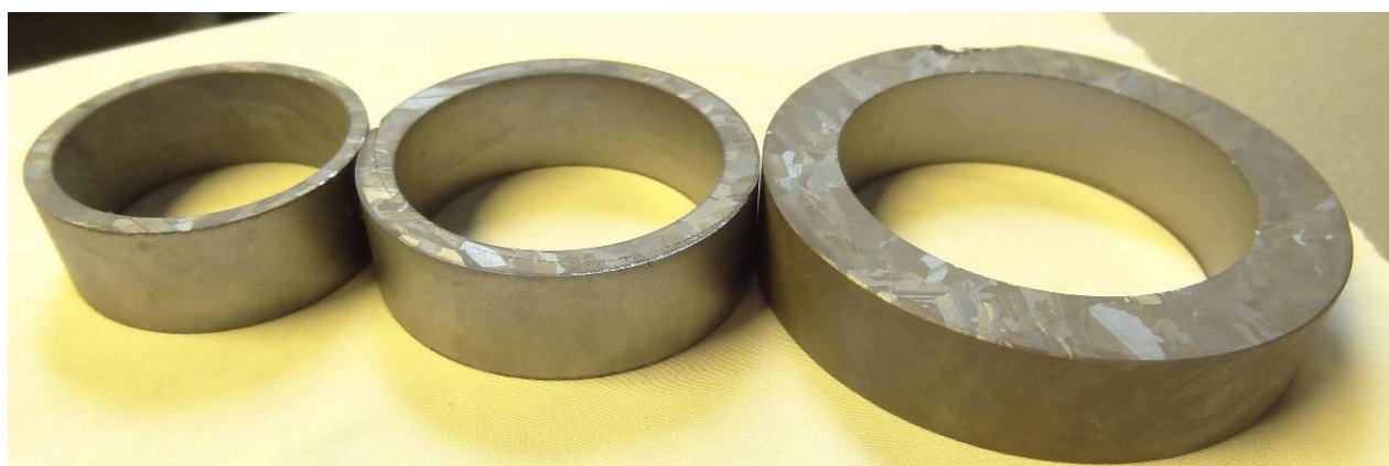
IMAGE 6: Image de la tranche de lingot de silicium poly-cristallin. (Vue supérieure)
