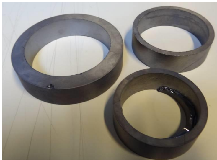
IMAGE 24: Image de la tranche de silicium mono cristallin coupée (Vue supérieure)
