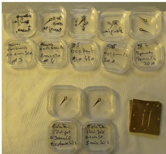
IMAGE 1: Image des aiguilles des heures coupées dans un substrat de laiton (or 1 et 2) (vue supérieure)
