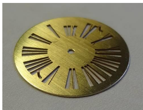
IMAGE 2: Représentation du tracé du cadran romain et pièce coupée dans un substrat de laiton (vue supérieure)
