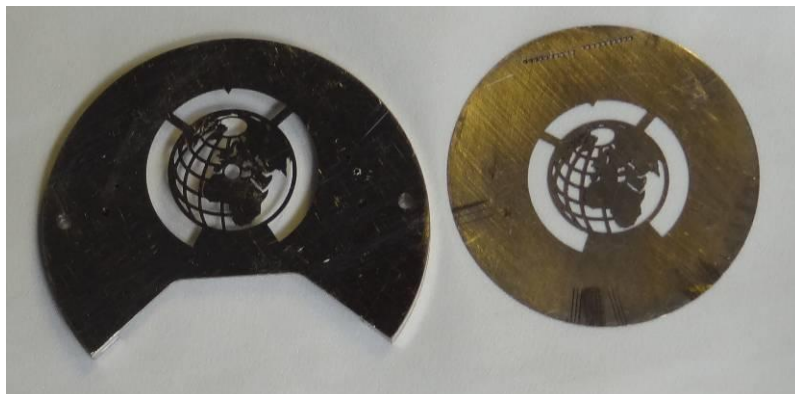
IMAGE 4: Image du tracé de la découpe du cadran « carte du monde » sur un substrat d'or blanc (Vue supérieure)
