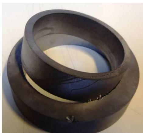
IMAGE 5: Image de la tranche de lingot de silicium mono-cristallin. (Vue supérieure)
