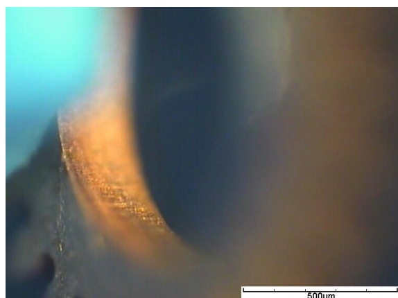
IMAGE 9: Imagerie de bordure de l'échantillon 36013R en CuBe.
