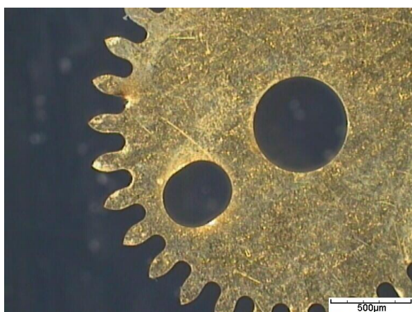
IMAGE 14: Imagerie de la face arrière de l'échantillon 36014R en maillechort 0.28.
