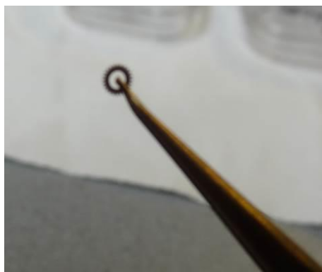
IMAGE 3: Photographie et image du tracé de la roue satellite 36013R (vue supérieure et latérale)
