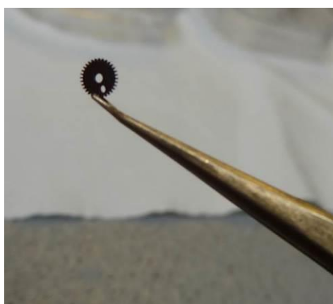
IMAGE 2: Photographie et image du tracé de l'entraîneur de satellite 36014R (vue supérieure et latérale)
