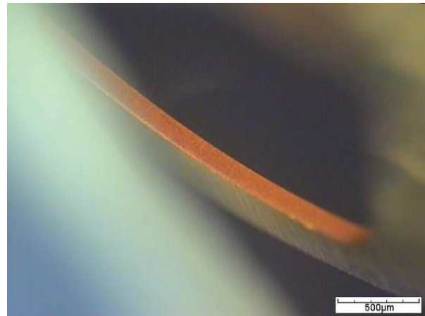
Figure 21: échantillon E, flanc de coupe (CuBe)
