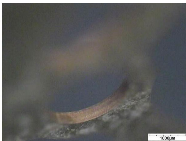
Figure 18: échantillon D, flanc de coupe (laiton, zoom x2,5)
