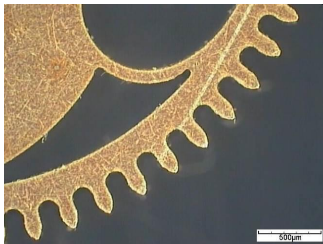
IMAGE 30 : Denture et motif, face avant, Durnico 0.45 mm, pièce 2
