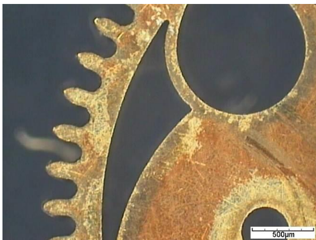
IMAGE 31 : Denture et motif, face arrière, Durnico 0.45 mm, pièce 2
