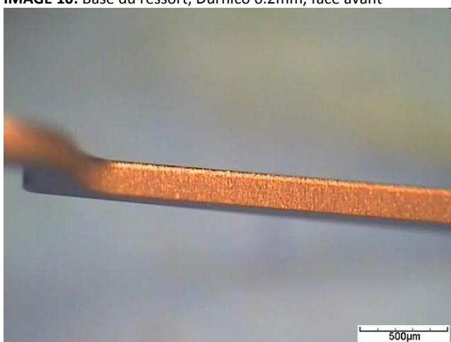
IMAGE 12: Flanc de la tige du ressort, Durnico 0.2mm, Ra : 0.27 µm
