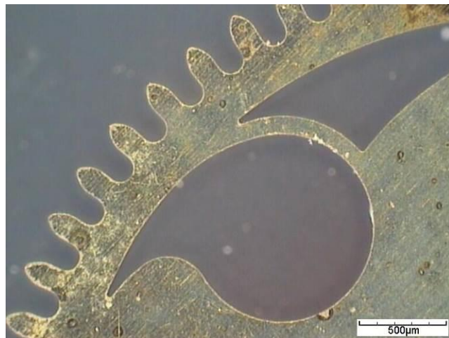
IMAGE 24 : Motif intérieur et dents, face arrière, Durnico 0.2 mm, pièce 2
