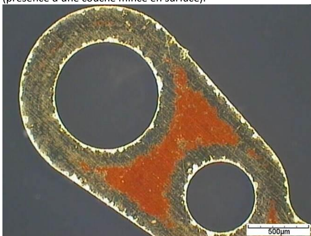
IMAGE 10: Base du ressort, Durnico 0.2mm, face avant
