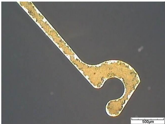
IMAGE 8: Crochet du ressort, Durnico 0.2mm, face avant. La coloration résiduelle est issue du traitement thermique (présence d'une couche mince en surface).
