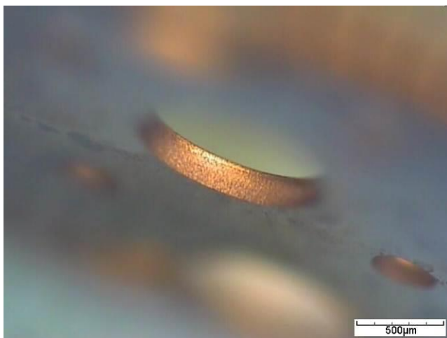
IMAGE 29 : Profil intérieur, Durnico 0.2 mm, pièce 5
