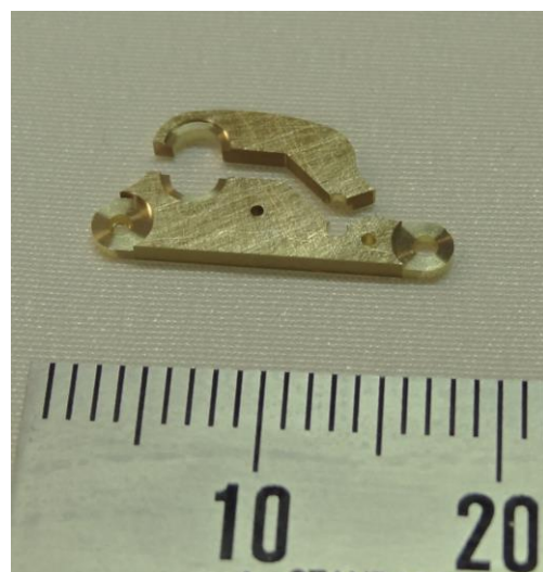
IMAGE 5,6 ET 7: Photographie des 3 types de pièces produites, respectivement le ressort RES14444DA 1.0, la roue ROE10046DA 1.0 et le pont PON1190DA 1.0 (vue supérieure)
