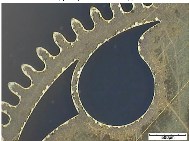
IMAGE 27 : Denture et motif intérieur, face avant, Durnico 0.2 mm, pièce 5
