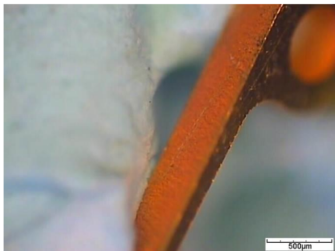
IMAGE 22: Bras, Flanc de coupe, laiton 0.45mm
