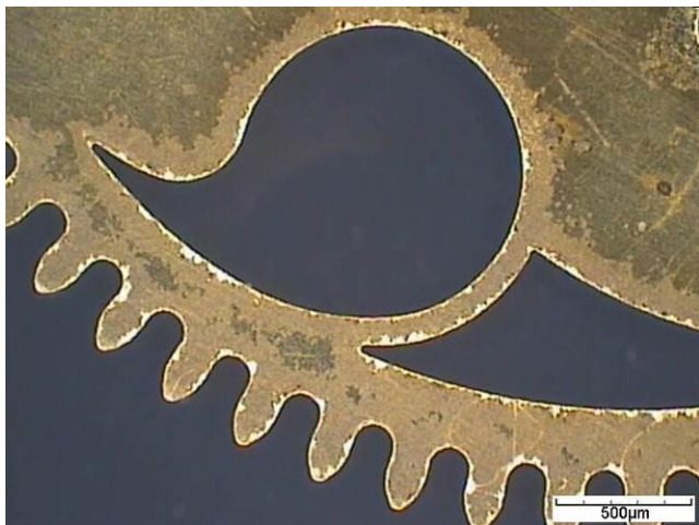
IMAGE 23 : Motif intérieur et dents, face avant, Durnico 0.2 mm, pièce 1
