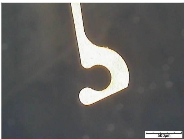
IMAGE 18: Crochet, flanc de coupe, CuBe 0.4mm
