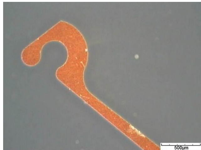
IMAGE 9: Crochet du ressort, Durnico 0.2mm, face arrière
