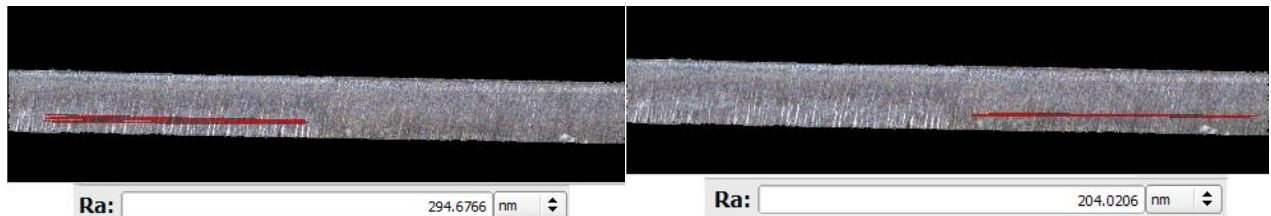
IMAGE 6: Mesures de rugosité pour une vitesse de 0.3 mm/s à gauche et une vitesse de 0.1 mm/s à droite
