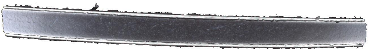
IMAGE 7: Mesure 3D Alicona du flanc de coupe après le traitement de surface
