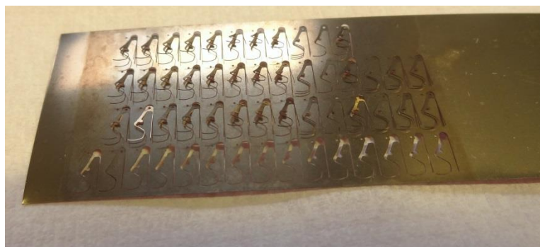
IMAGE 2: Photographie d'une série de ressorts après production d'une plaquette de Phynox brut
