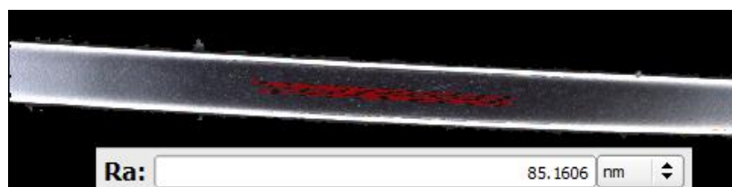
IMAGE 8: Mesure de rugosité après le traitement de surface
